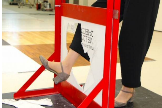
隔壁板蹴破り中
